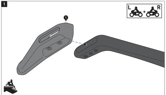
Stecken Sie beidseitig die Windabweiser (1) auf die Hebelschützer.
