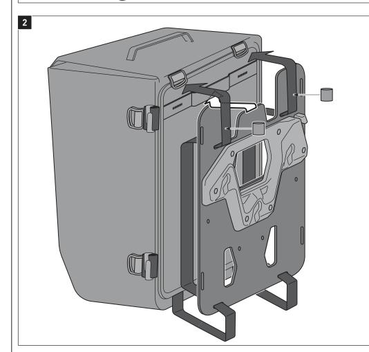
Verschlaufen Sie die Adapterplatte zunächst locker mit den vertikalen Gurten an der SysBag. Schieben Sie dabei die mittlere Nase der Adapterplatte unter die gezeigte Lasche am Taschenrü-
