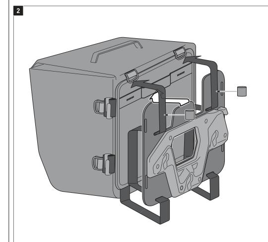
Verschlaufen Sie die Adapterplatte zunächst locker mit den vertikalen Gurten an der SysBag. Schieben Sie dabei die mittlere Nase der Adapterplatte unter die gezeigte Lasche am Taschenrücken.
