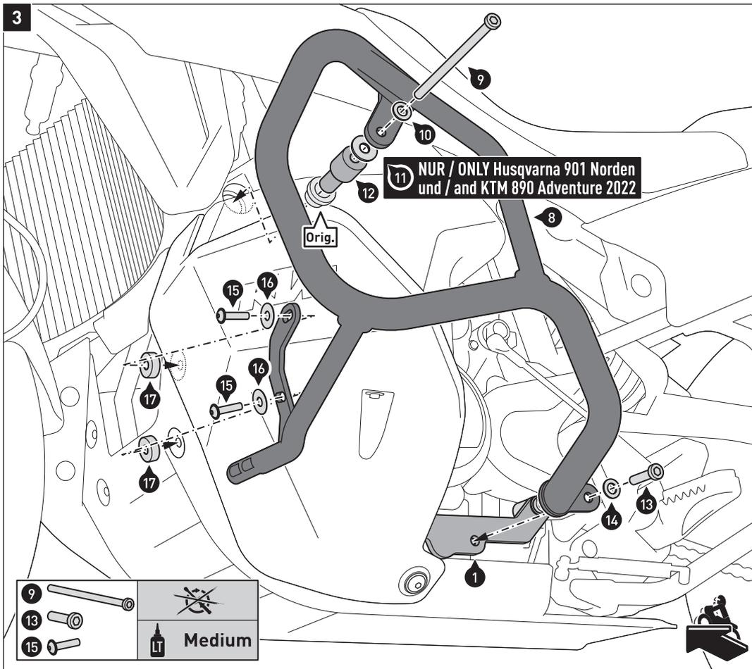
Verschrauben Sie den Sturzbugel (8) am Fahrzeug und dem Anbaublech (1).
