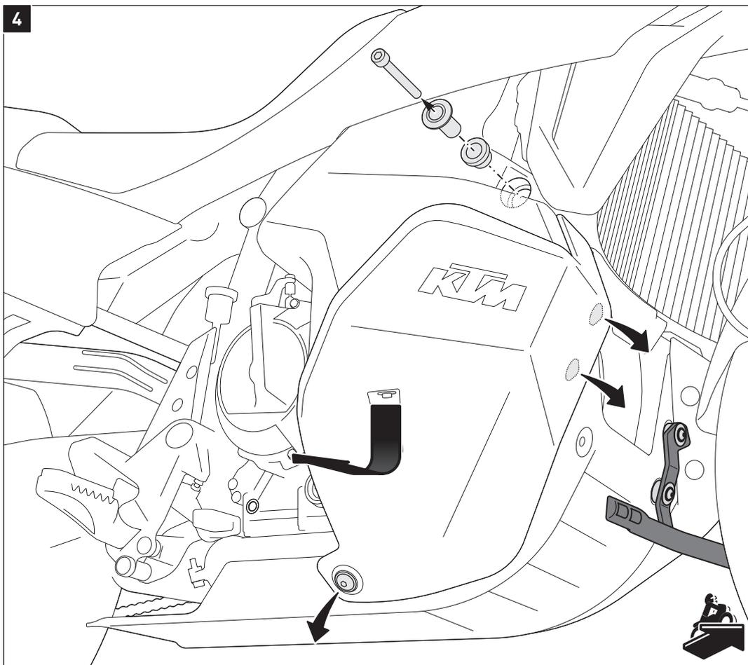
Entfernen Sie die gezeigten original Teile auf der **rechten** Fahrzeugseite.
