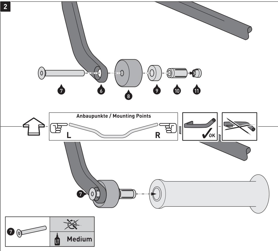
Verschrauben Sie die gezeigten Teile locker mit den Bügeln (6), wie in der oberen Zeichnung gezeigt.
