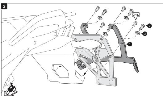
⚠ HINWEIS: Bei Modellen ab 2021 sind die original Schrauben (Orig.) nicht enthalten. Verwenden Sie stattdessen die Schrauben (2) und die Unterlegscheiben (3).
