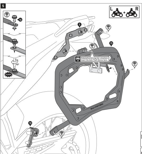
Verbinden Sie die Seitenträger (15) mit den Schnellverschlüssen (16) an den Befestigungslaschen (5), (10) und (11) sowie dem Querverbinder (3)
