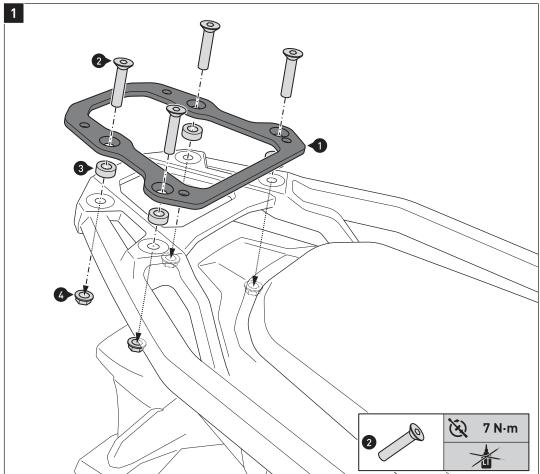
Montieren Sie das Anbaublech (1) am Gepäckträgerrahmen, wie in der Zeichnung gezeigt. Ziehen Sie die Schrauben wie vorgegeben an.
