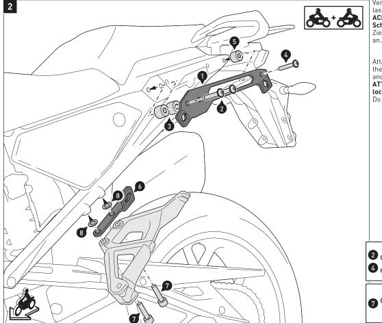
Verschrauben Sie die Befestigungs-laschen (1) und (6) am Fahrzeug. **ACHTUNG: Verwenden Sie flüssige** Schraubensicherung!
