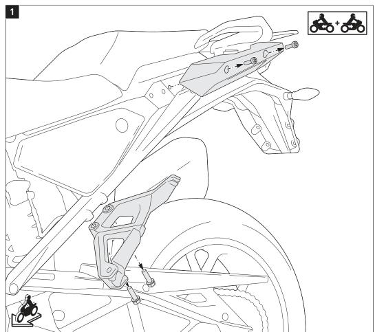
Entfernen Sie die original Schrauben, Fußrastenhalter und Kunsstoffverkleidungen beidseitig vom Fahrzeug.
