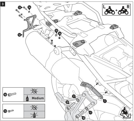
Verschrauben Sie beidseitig die Befestigungslaschen (9) mit den Soziusfußrastenhaltern am Fahrzeug, wie in der Zeichnung
