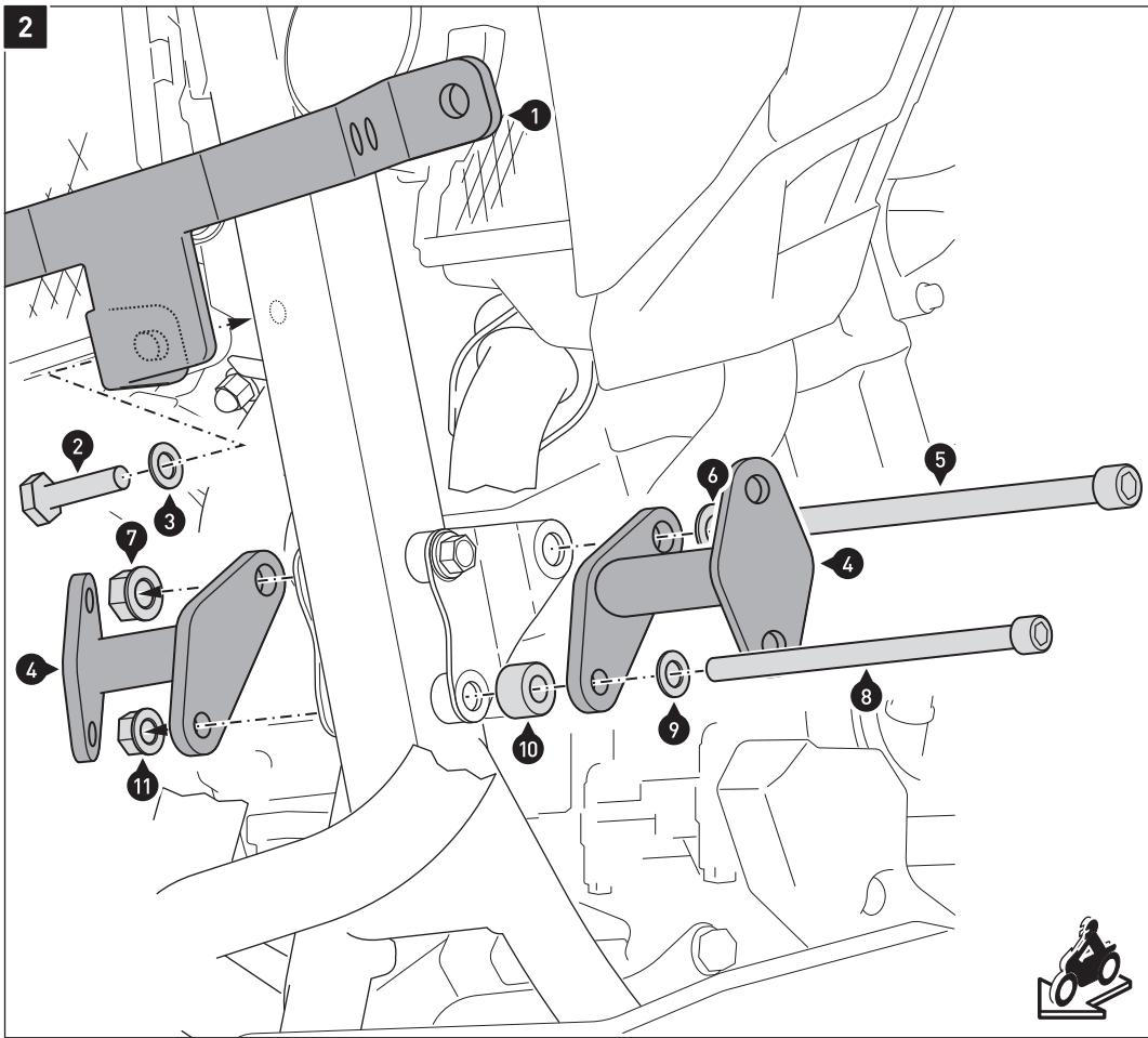
Montieren Sie den Querverbindler (1) und die Anbaustreben (4) am Fahrzeugrahmen, wie in der Zeichnung gezeigt.
