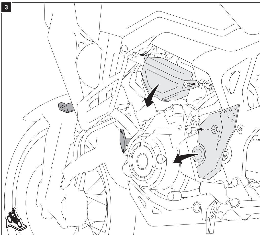
Lösen Sie die gezeigten originalen Schrauben und entfernen Sie die Werkzeugbox und den Fersenschutz von der linken Fahrzeugseite.
