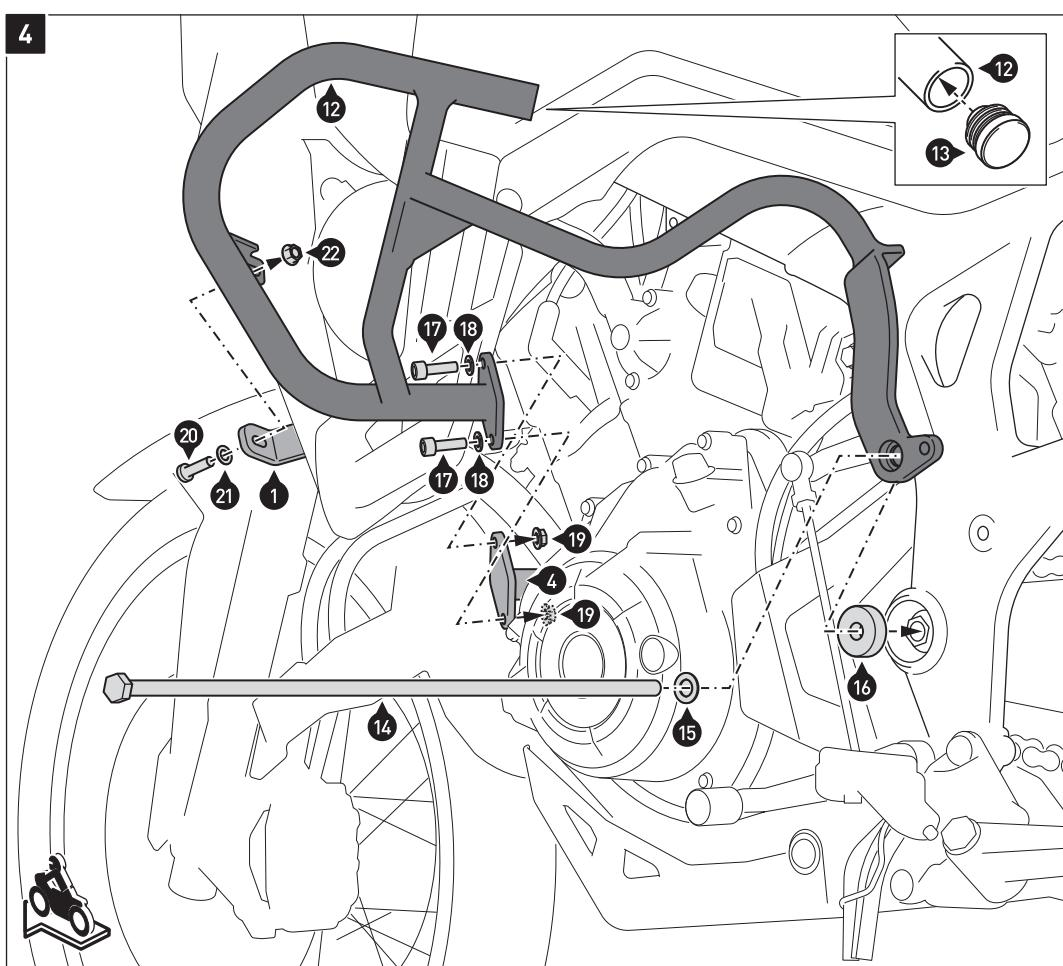
Setzen Sie den Kunststoffendstopfen (13) in den Schutzbügel (12) ein.
