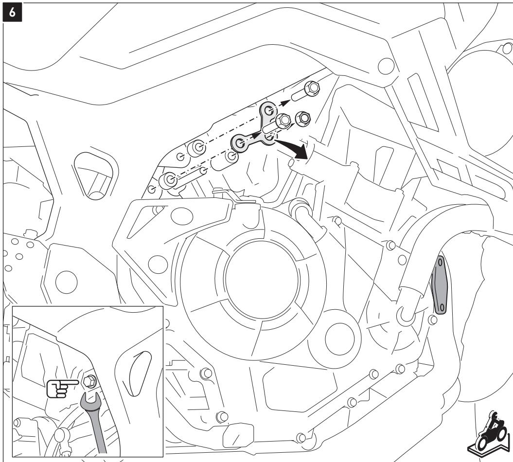
Entfernen Sie die gezeigten originalen Schrauben, Mutter, Anbaublech und Distanzbeschlägen von der rechten Fahrzeugseite. Um die Mutter zu lösen, muss der in der Detailzeichnung gezeigte Schraubensack (linke Fahrzeugseite, hinter der Werkzeugbox) gehalten werden.
