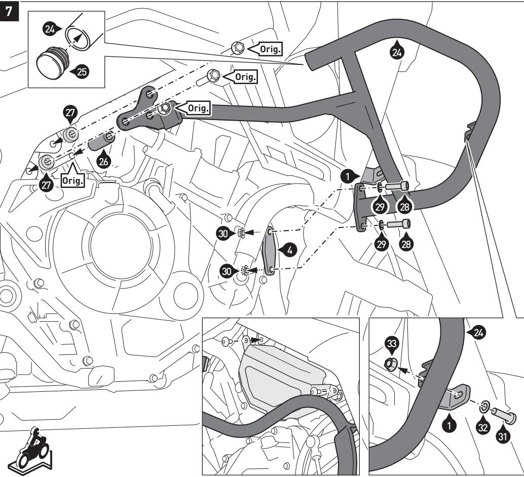
Setzen Sie den Kunststoffendstopfen (25) in den Schutzbügel (24) ein. Verschrauben Sie anschließend den Schutzbügel (24) am Fahrzeug bzw. dem Querverbinder (1) und der linken Anbaustrebe (4), wie in der Zeichnung gezeigt. Verwenden Sie am oberen Montagepunkt die originale Schrauben (Orig.) und Mutter (Orig.) (siehe Schritt [6]).
