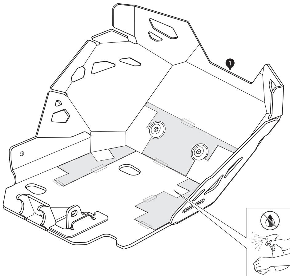
Reinigen Sie die Oberfläche des Motorschutzes (1) gründlich von Fett- und Schmutzrückständen.
