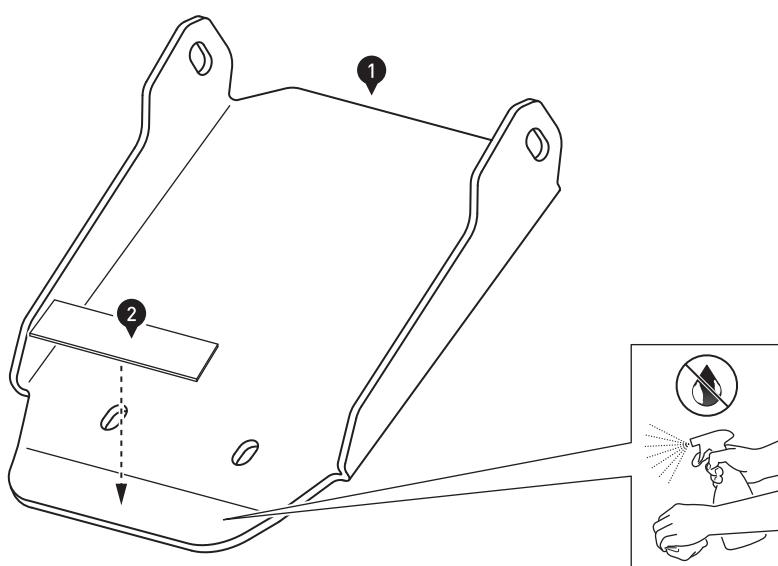
Reinigen Sie die Oberfläche der Motorschutz-Verlängerung (1) gründlich von Fett- und Schmutzrückständen. Kleben Sie den Schonstreifen (2) auf, wie in der Zeichnung dargestellt.
