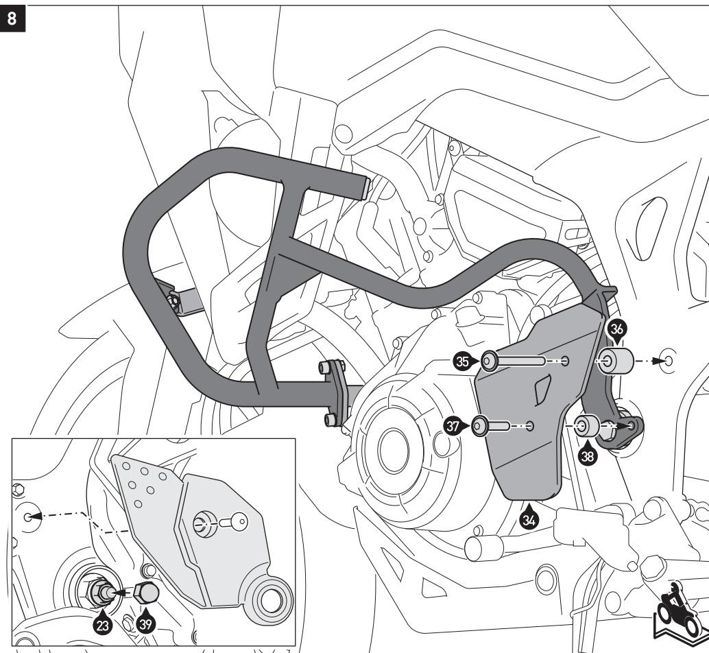
Verschrauben Sie das Abdeckblech (34) auf der linken Fahrzeugseite, wie in der Zeichnung gezeigt.
