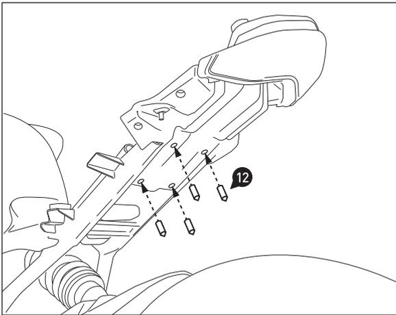
**5** Verschrauben Sie nun die Körner (12) am Fahrzeug, wie in der Zeichnung gezeigt. Die Gewinde bis auf 10 mm Überstand einschrauben.
