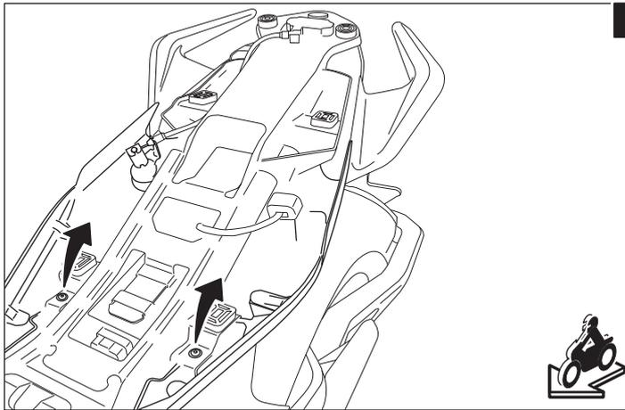
**1** Entfernen Sie die Sitzbank vom Fahrzeug. Entfernen Sie die markierten Schrauben.
