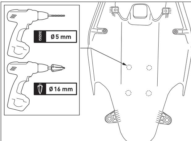
**7** Demontieren Sie die Verkleidung erneut. Bohren Sie mit einem 5-mm-Metalldrill die Führungsbohrungen. Benutzen Sie einen Schälbohrer, um 16-mm-Öffnungen von der Innenseite durch die Verkleidung zu bohren. Nutzen Sie die in Schritt 6 erzeugten Körnungen als Bohrmittelpunkt. Entgraten Sie anschließend die Ränder der Öffnungen.
