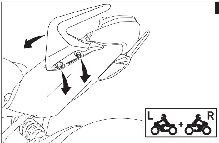
**3** Entfernen Sie die markierten Schrauben und die Haltegriffe vom Fahrzeug.
