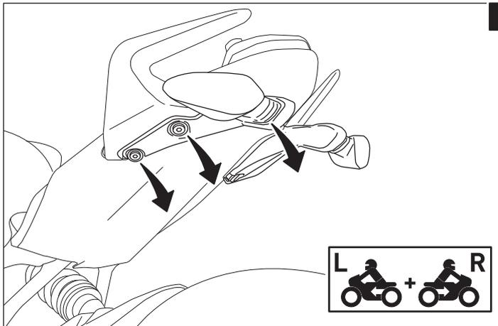
**2** Lösen Sie die markierten Schrauben und entfernen Sie die Blinker vom Fahrzeug.
