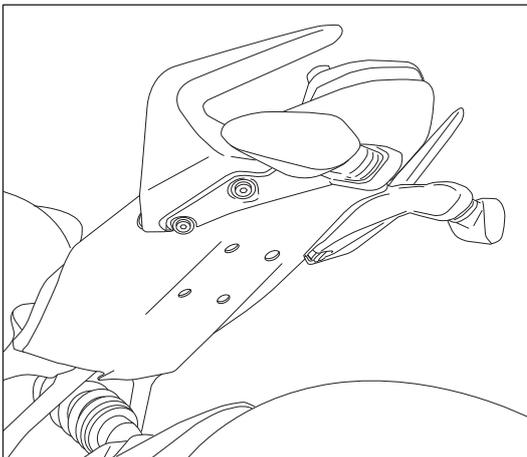
**8** Verschrauben Sie die in Schritt 1, 2 und 3 demontierten Teile wieder am Fahrzeug.
