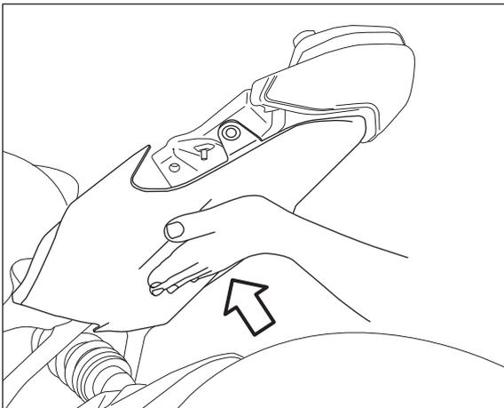
**6** Verschrauben Sie die in Schritt 1 demontierte Verkleidung wieder am Fahrzeug.
