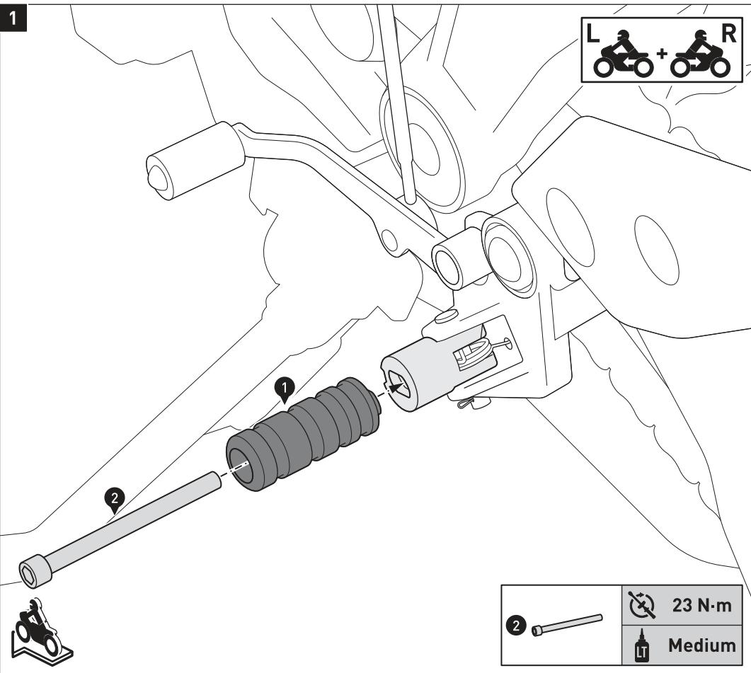
Montieren Sie beidseitig die Fußrasten (1) an dem montierten Gelenkadapter (Beispiel-Fahrzeug gezeigt).
