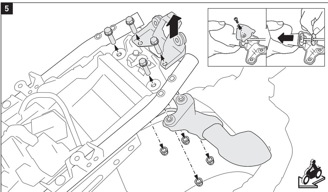
Lösen Sie die gezeigten Schrauben und entfernen Sie die Rücklichthalterung und den Blinkerhalter vom Fahrzeug.
