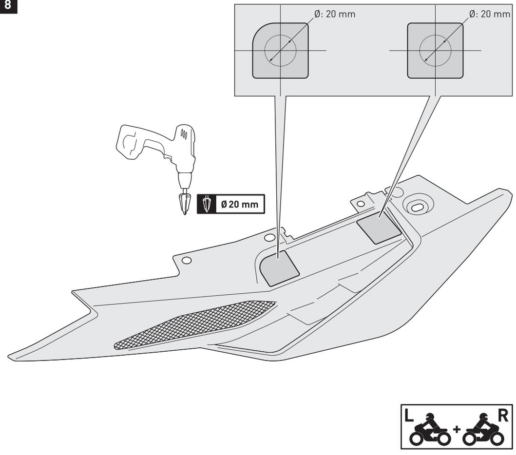
Bohren Sie nun die Montageöffnungen in die demontierten Seitenverkleidungen.
