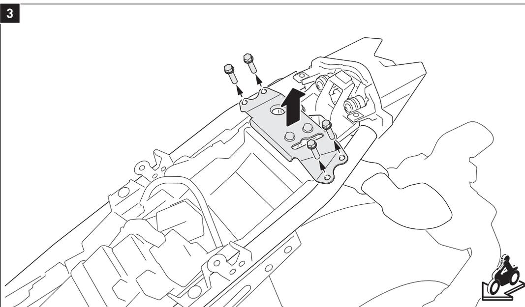
Lösen Sie die gezeigten Schrauben und entfernen Sie das Sitzverriegelungsblech vom Fahrzeug.
