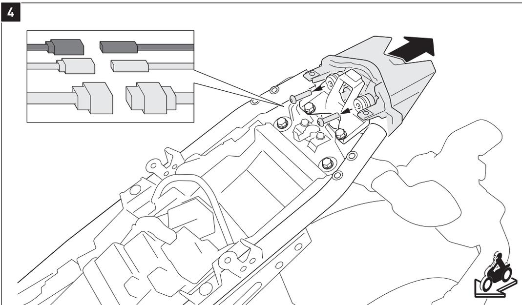
Lösen Sie die Steckverbindungen der Blinker und des Rücklichts.
