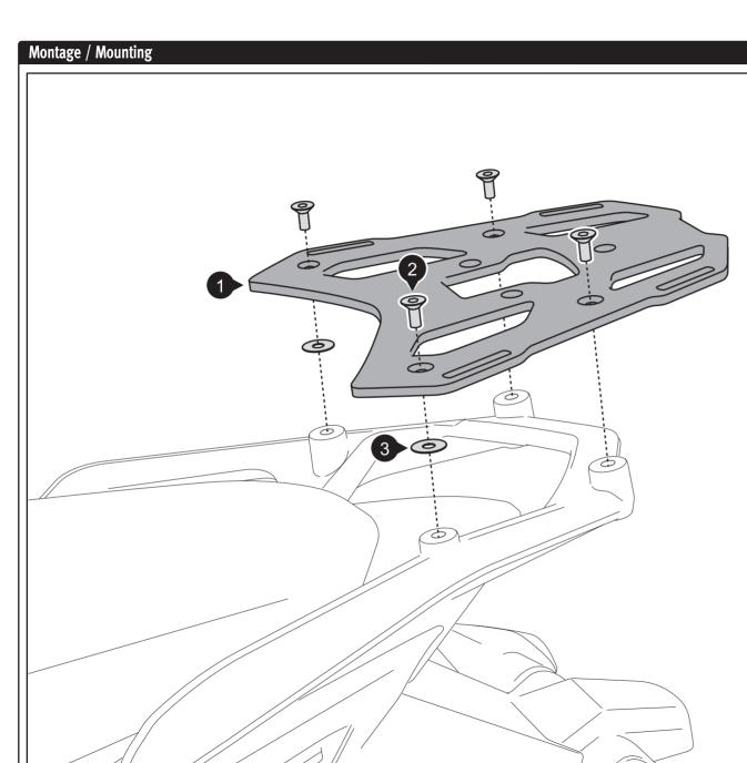
Wenn Sie das ALU-RACK mit dem SW-MOTECH QUICK-LOCK EVO Kofferträger montieren wollen, entfallen die Schrauben (2). Verwenden Sie die Schrauben (4) und Distanzbuchsen (5). Verschrauben Sie das ALU-RACK mit dem Befestigungsblech (dem Kofferträger beiliegend), wie im Detailbild gezeigt.
