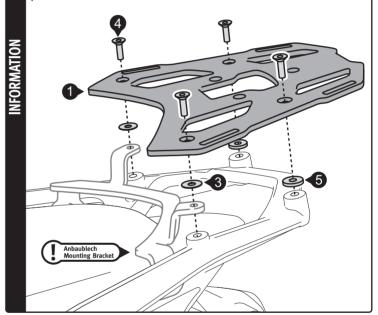
Sichern Sie alle Schrauben mit flüssiger Schraubensicherung. Achtung: Falls die Montage einer Adapterplatte vorgesehen ist, MÜSSEN die Haltenocken am ALU-RACK vor dessen Anbau am Motorrad verschraubt werden.
