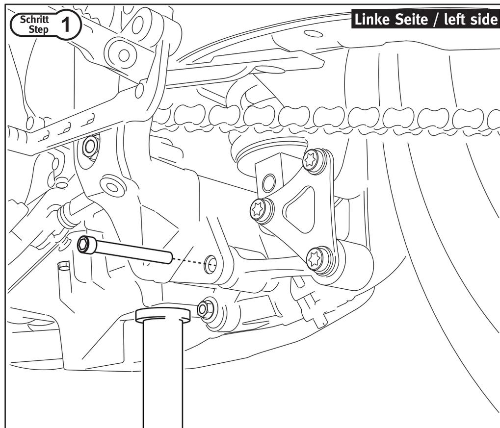
Stützen Sie das Fahrzeug mit einem geeigneten Heber ab. Achten Sie darauf, dass die Hinterradschwinge entlastet ist. Entfernen Sie anschließend die in der Zeichnung gezeigte originale Schraube.
