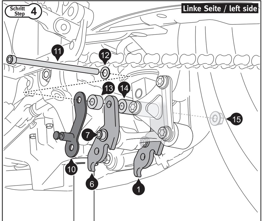
Verschrauben Sie nun die Federanlenkung (10) mit den Anbaublechen (1) und (6). Drehen Sie die Federanlenkung (10) ein wenig nach hinten, um die Schraube (7) leicht erreichen zu können. Ziehen Sie anschließend die Schraube (11) leicht an. Ziehen Sie nun die Schraube (7) nach Vorgabe an. Anschließend Schraube (11) lösen und die Federanlenkung (10) wieder in Position bringen.
