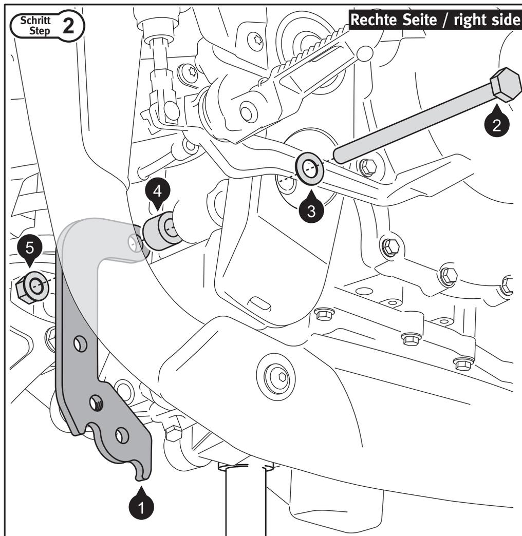
Entfernen Sie die originale Motorhalteschraube vom Montagepunkt. Verschrauben Sie anschließend das Anbaublech (1), wie in der Zeichnung gezeigt. Ziehen Sie die Schraube (2) noch nicht an.
