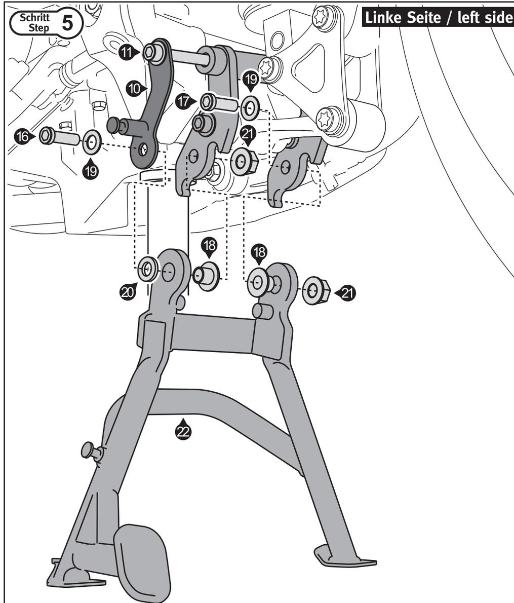
Setzen Sie die Laufbuchsen (18) mit Schmierfett in die Öffnungen des Hauptständers (22) ein. Verschrauben Sie nun den Hauptständer (22) mit den Anbaublechen (1) und (6) sowie der Federanlenkung (10). Ziehen Sie nach Montage aller Teile die Schrauben (11), (16) und (17) nach Vorgabe an.
