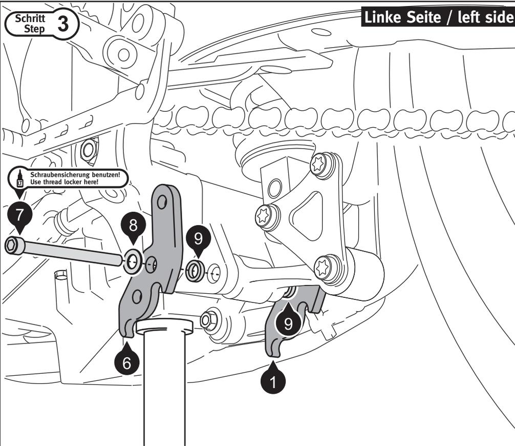
Verschrauben Sie nun das Anbaublech (6), wie in der Zeichnung gezeigt. Sichern Sie Schraube (7) mit flüssiger Schraubensicherung. Ziehen Sie Schraube (7) noch nicht an.
