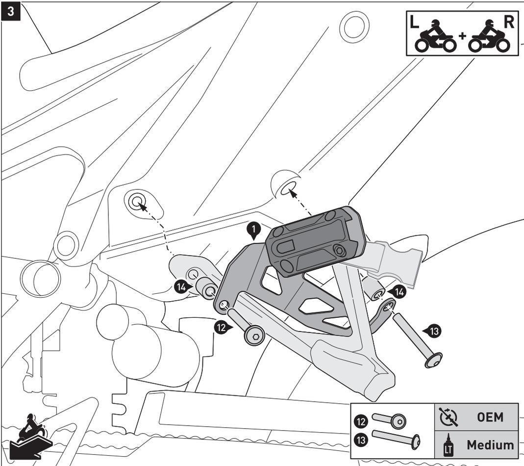
Lösen Sie die original Schrauben der Soziusfußrastenhalter und entfernen Sie diese vom Fahrzeug.
