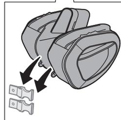
Montieren Sie die gezeigten Teile an den Anbaublechen (1) (linkes Anbaublech gezeigt).
