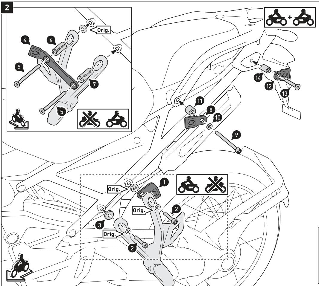
Verschrauben Sie die Befestigungs-laschen (1), (4), (8) und (12) **beidseitig** mit den gezeigten original Unterlegscheiben und Buchsen (Orig.) am Fahrzeug.
