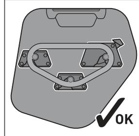
Setzen Sie die drei Arretierungsöffnungen des Seitenkoffers auf die Führungsbolzen des montierten SLC Seitenträgers. Drücken Sie anschließend den Seitenkoffer leicht nach unten, bis dieser fest am SLC Seitenträger sitzt.
