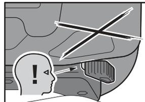
SICHTBARE ROTE MARKIERUNG: NICHT korrekt verriegelt! Verlustgefahr!
