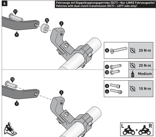
Befestigen Sie die innenliegenden Enden der Bügel (7) an den Verbindungsstücken (2).
