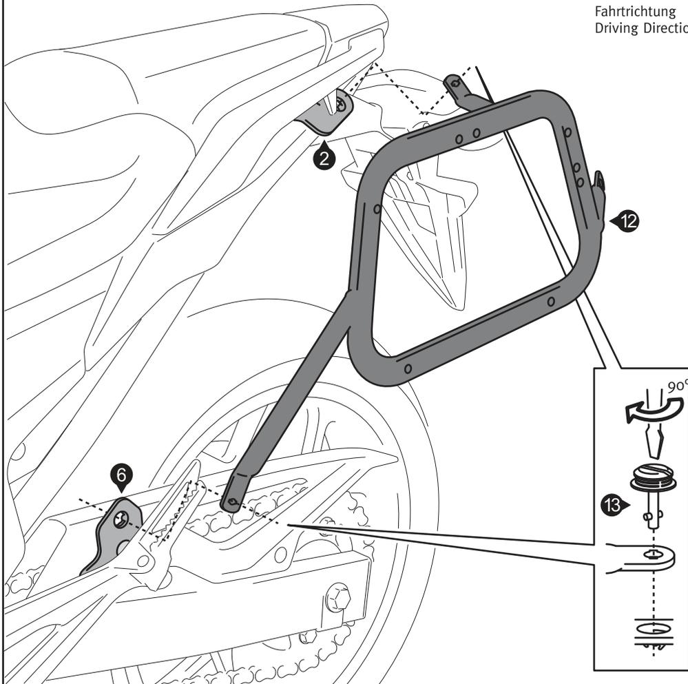
Befestigen Sie die beidseitig die Kofferträger (12) mit den Schnellverschlüssen (13) an den Anbaublechen (2) und (6).
