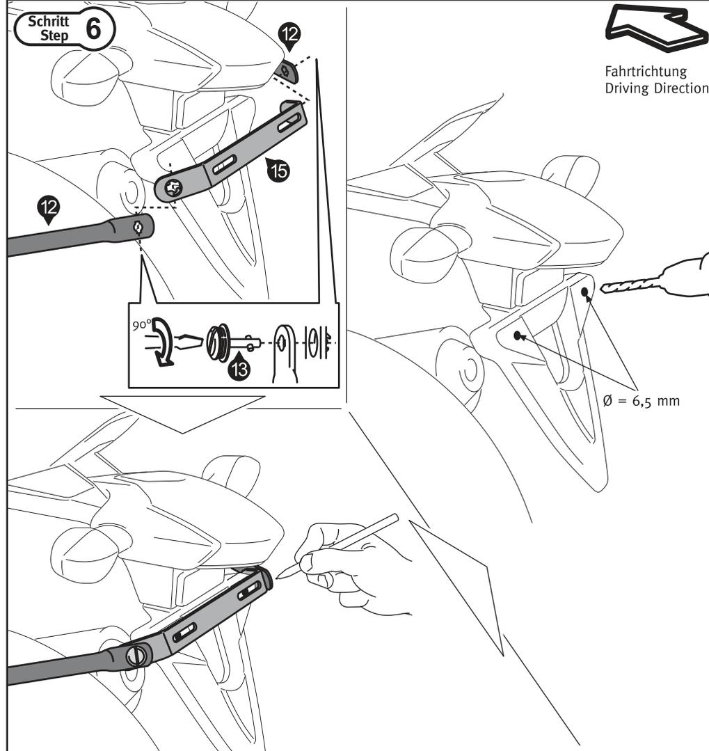
Verbinden Sie beide Kofferträger (12) an den hinteren Befestigungsauslegern mit dem Querverbinder (15). Benutzen Sie auch hier die Schnellverschlüsse (13).
