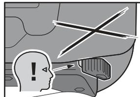
SICHTBARE ROTE MARKIERUNG: NICHT korrekt verriegelt! Verlustgefahr!
