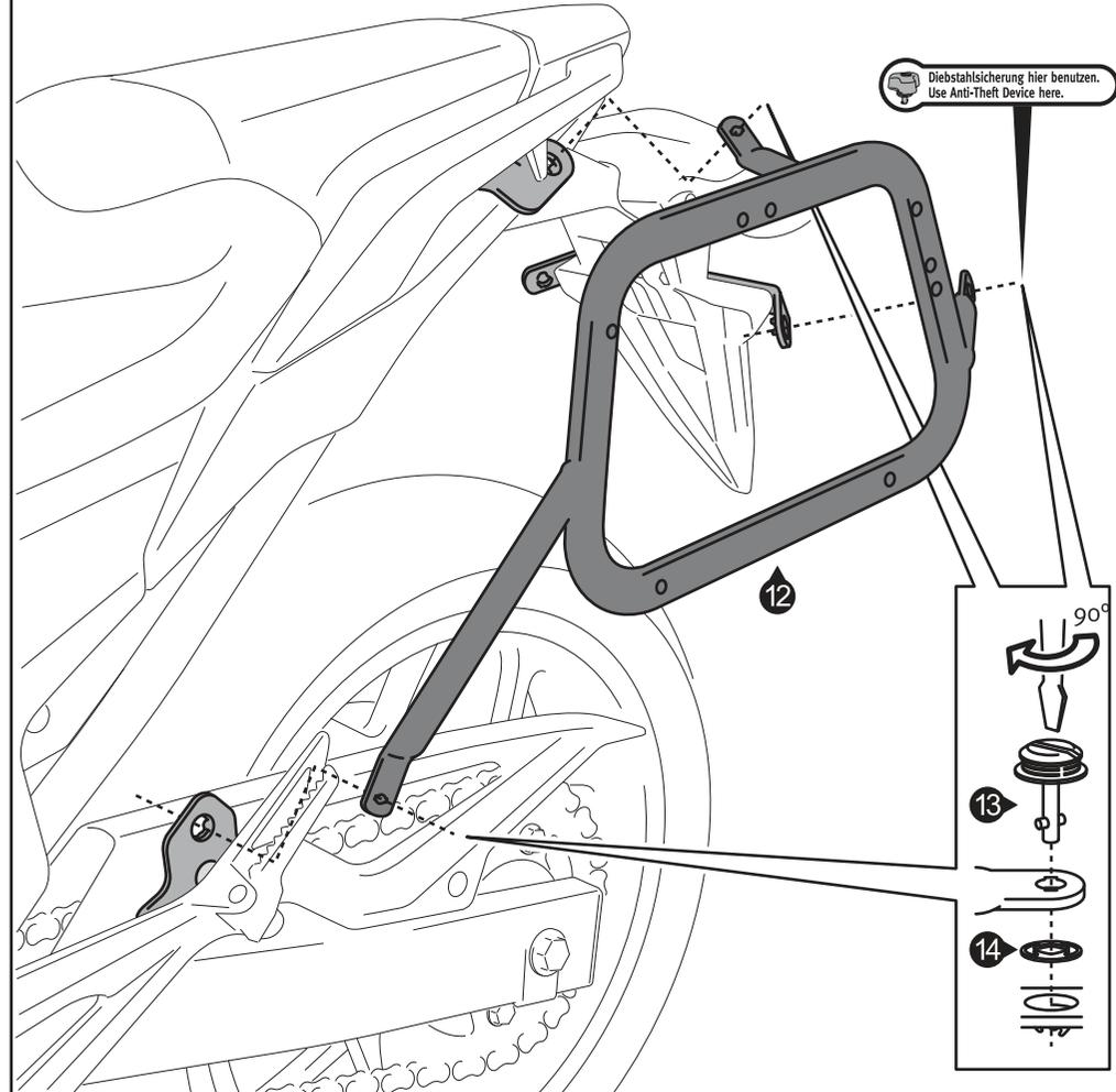
Befestigen Sie beidseitig die Koffertträger (12) mit den Schnellverschlüssen (13) an den Befestigungsblechen (2) und (6) bzw. Querverbinder (15). Sichern Sie die Schnellverschlüsse (13) mit den Sicherungsscheiben (14). Wenn alle Komponenten spannungsfrei und symmetrisch sitzen, ziehen Sie die Schrauben (3), (7), (10) und (16) (in dieser Reihenfolge) nach den Vorgaben an:
