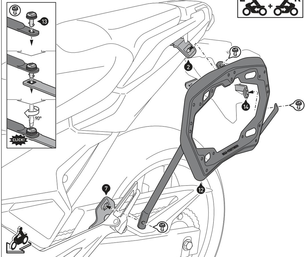
Verbinden Sie die beiden Kofferträger (12) mit den Befestigungslaschen (2) und (7); verwenden Sie die Schnellverschlüsse (13), wie in der Detailzeichnung gezeigt.
