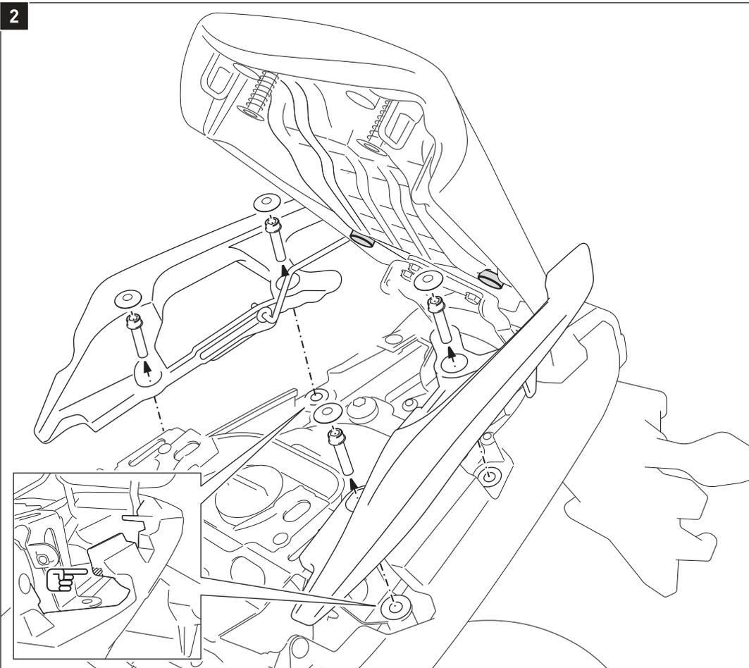
Entfernen Sie die Kunststoffkappen und die original Schrauben der Sozjus-Haltegriffe.
