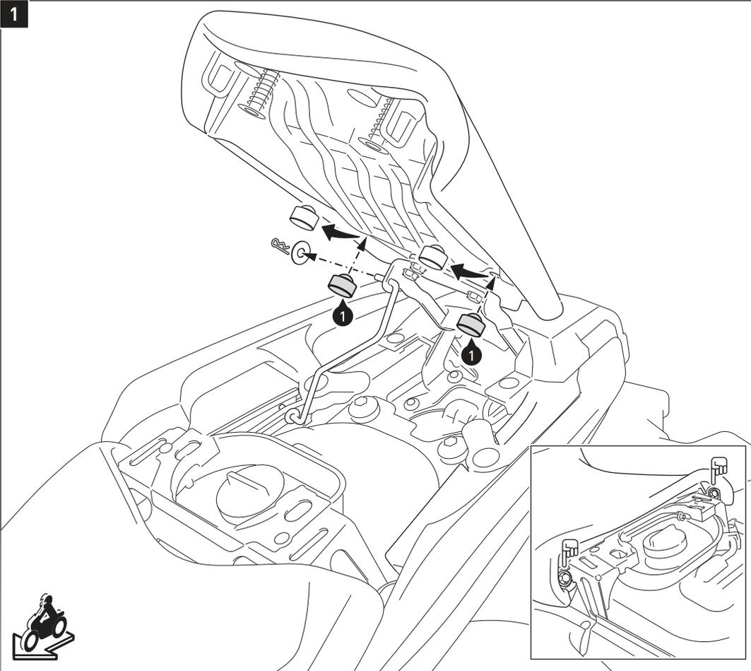
Öffnen Sie den Soziussitz. Entfernen Sie die gezeigten original Sitzbank-Gummis und ersetzen Sie diese durch die Gummidämpfer (1).
