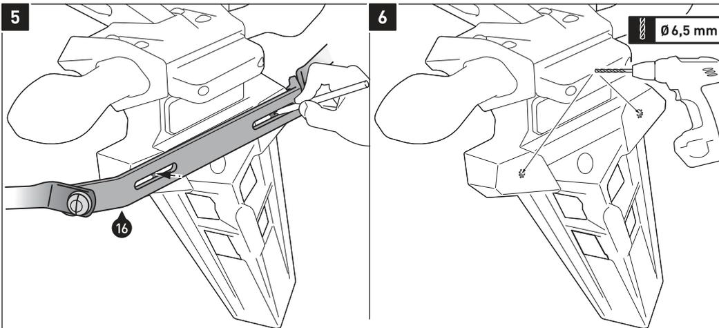
**HINWEIS:** Führen Sie die Schritte [5] und [6] nur durch, falls die Montagebohrungen des Kotflügels nicht mit dem Lochbild des Querverbinders (16) übereinstimmen.
