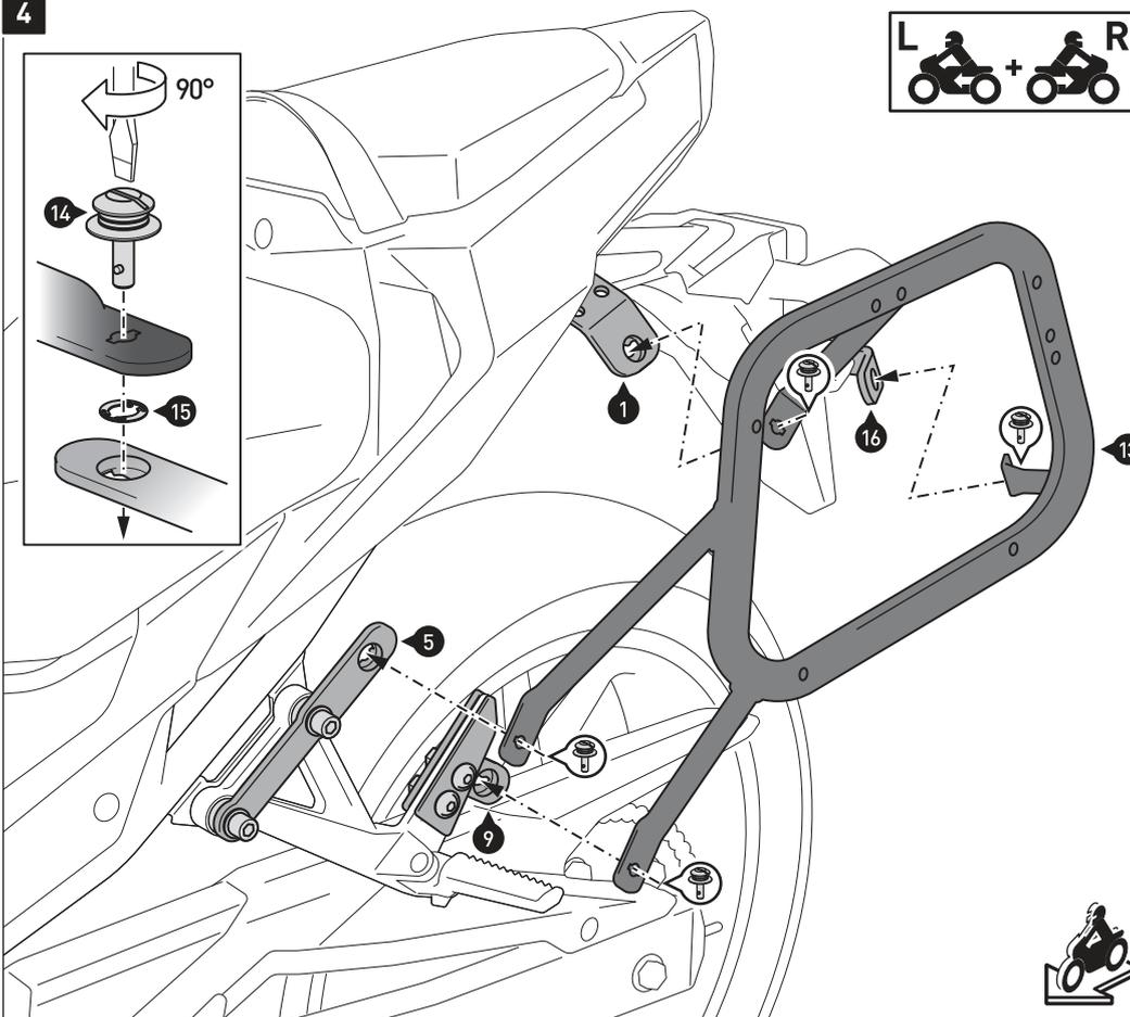
Verbinden Sie die beiden Kofferräger [13] mit dem Querverbinder [1] und den Befestigungs-laschen [5] und [9]; verwenden Sie die Schnellverschlüsse [14], wie in der Detailzeichnung gezeigt. Sichern Sie die Schnellverschlüsse [14] mit den Sicherungsscheiben [15].
