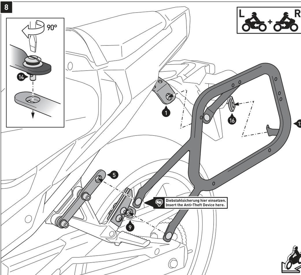
Verbinden Sie die Kofferräger (13) mit den Schnellverschlüssen (14) an den Befestigungslaschen (5) und (9) und den Querverbindern (1) und (16).
