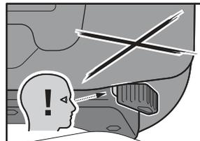
SICHTBARE ROTE MARKIERUNG: NICHT korrekt verriegelt! Verlustgefahr!
