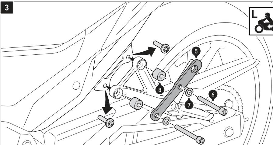
Entfernen Sie beidseitig die originalen Schrauben der Sozius-Fußrasten vom Fahrzeug.
