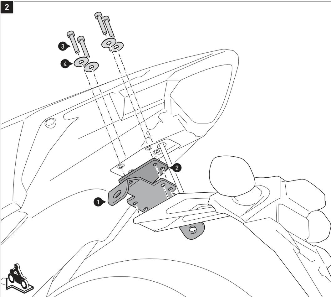
Verschrauben Sie den Querverbinder (1) mit der Distanzplatte (2) zwischen Fahrzeug und Kotflügel, wie in der Zeichnung gezeigt.
