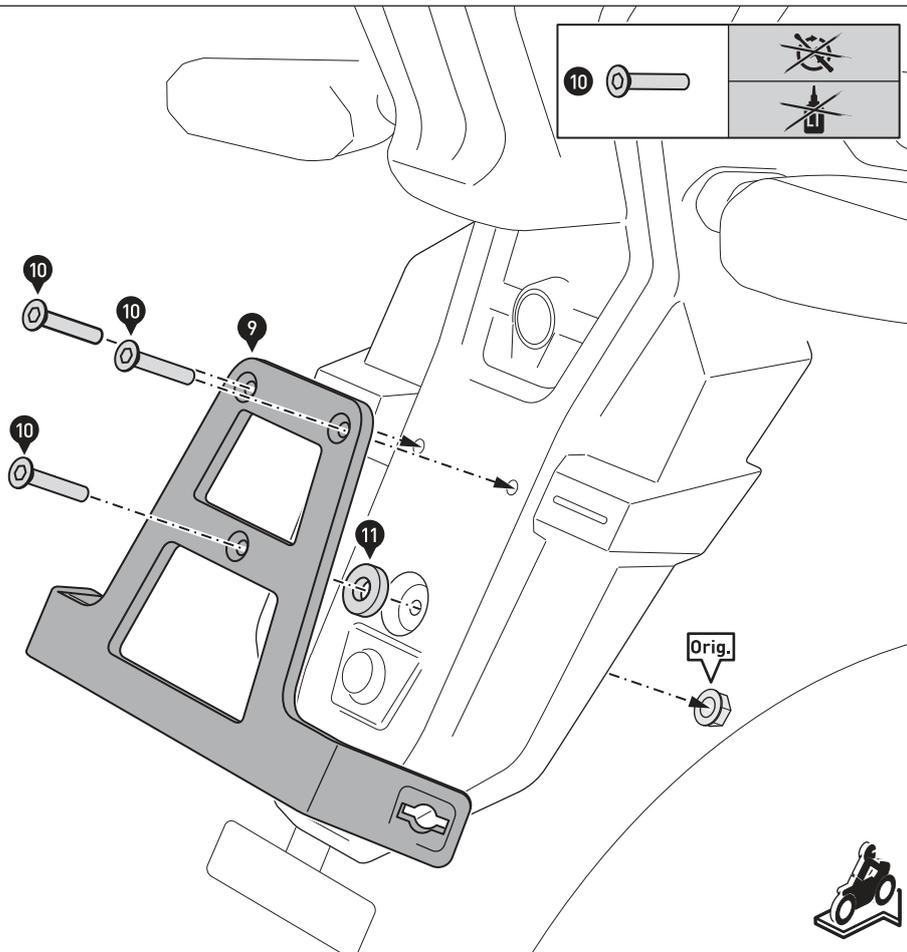
Entfernen Sie die original Schrauben vom Kennzeichenhalter.
