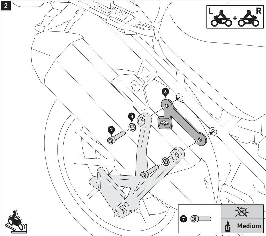
Lösen Sie beidseitig die Verschraubung der Soziusfußrasten.
