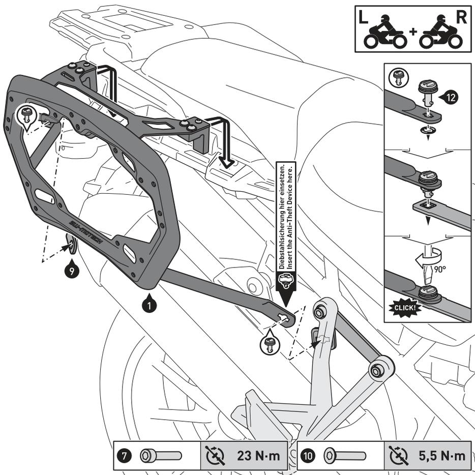
Setzen Sie die Einschubnasen der Seitenträger (1) beidseitig in die Öffnungen der Heckverkleidung ein.
