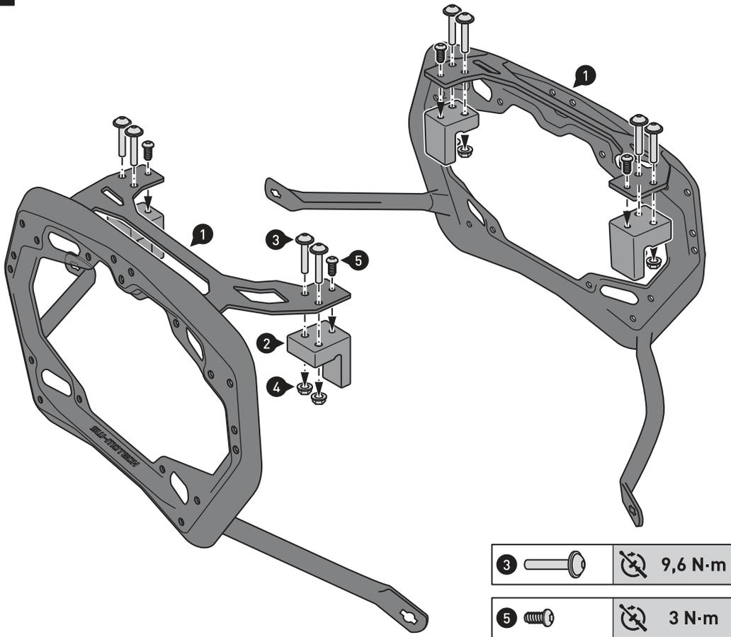
Verschrauben Sie die Einschubnasen (2) an den Seitenträgern (1), wie in der Zeichnung gezeigt. Ziehen Sie die Schrauben wie vorgegeben an.
