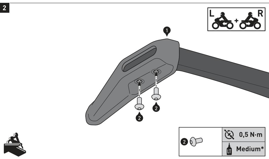
Montieren Sie die Windabweiser (1) an den Hebeleinschüssen.
