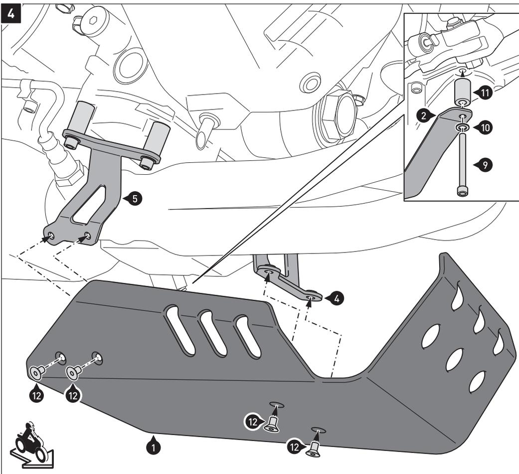
Verschrauben Sie den Motorschutz (1) mit der Schraube (12) an den Anbaublechen (4) und (5), wie in der Zeichnung gezeigt.
