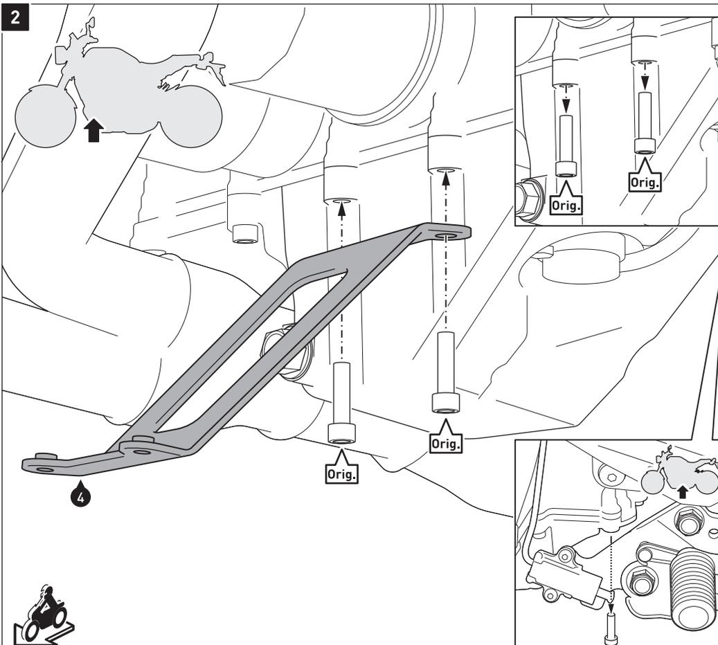
Entfernen Sie die originalen Schrauben (Orig.) von den Anbaupunkten, wie in der oberen Detailzeichnung gezeigt.
