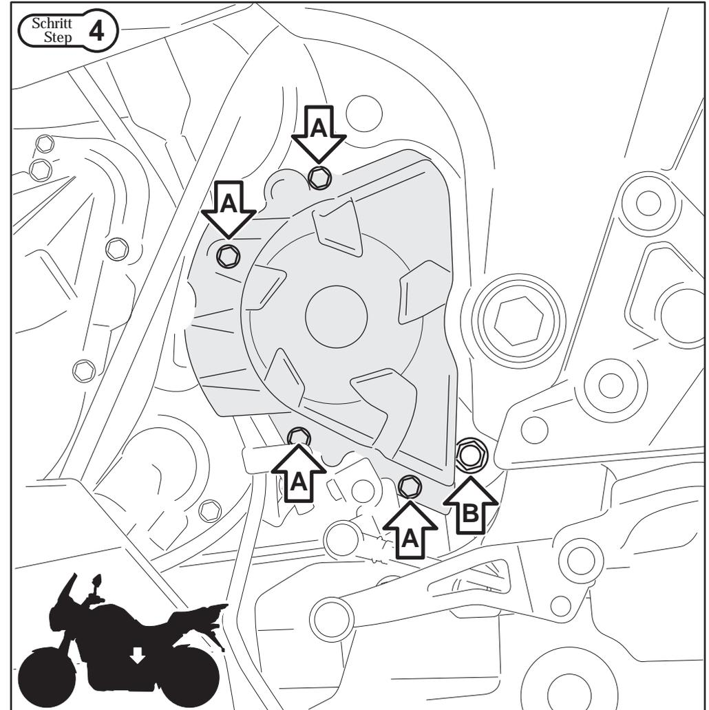
Entfernen Sie die originalen Schrauben A von der Ritzelabdeckung. Entfernen Sie die Ritzelabdeckung vom Fahrzeug. Lösen Sie anschließend Mutter B und entfernen Sie diese mit der originalen Schraube vom Fahrzeug.
