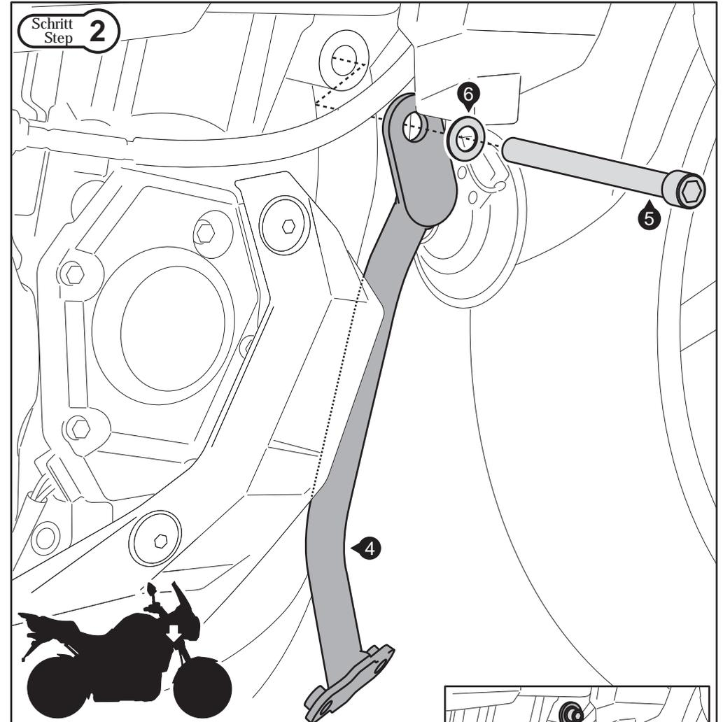
Entfernen Sie die originale Schraube vom rechten Anbaupunkt. Verschrauben Sie nun die Haltestrebe (4) am Fahrzeug, wie in der Zeichnung gezeigt. Benutzen Sie flüssige Schraubensicherung. Ziehen Sie die Schraube noch nicht an.
