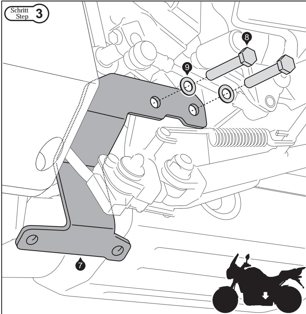
Entfernen Sie die originalen Schrauben vom Seitenständer. Verschrauben Sie nun das Anbaublech (7) am Fahrzeug, wie in der Zeichnung gezeigt. Ziehen Sie die Schraube noch nicht an.
