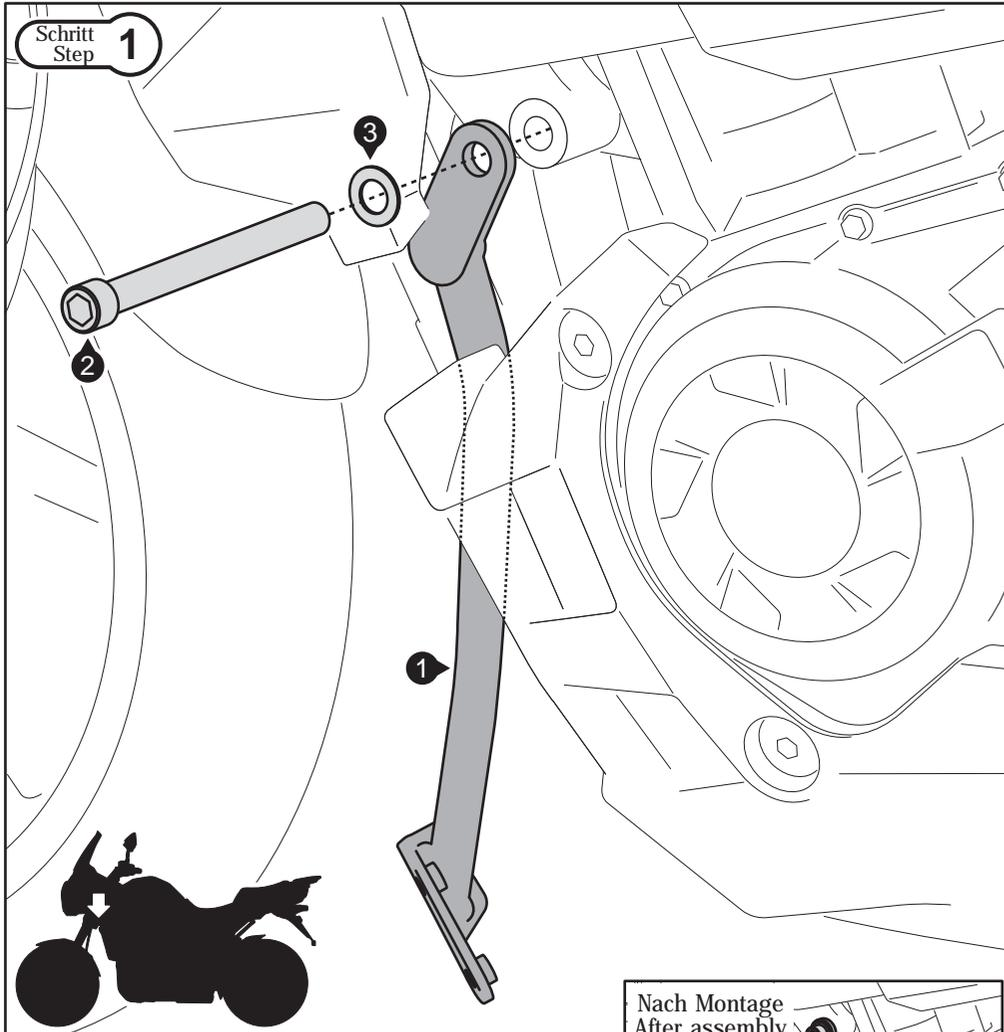
Entfernen Sie die originale Schraube vom linken Anbaupunkt. Verschrauben Sie nun die Haltestrebe (1) am Fahrzeug, wie in der Zeichnung gezeigt. Benutzen Sie flüssige Schraubensicherung. Ziehen Sie die Schraube noch nicht an.
