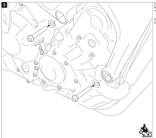
Entfernen Sie die originalen Motorhalteschrauben auf der rechten Fahrzeugseite.
