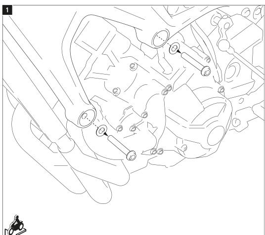
Stützen Sie den Motor mit einem geeigneten Heber ab.
