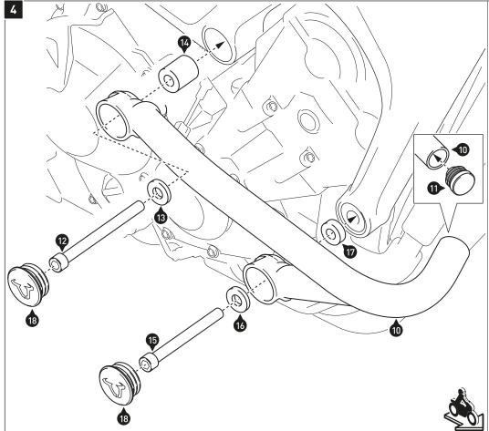
Setzen Sie den Kunststoffendstopfen (11) in den Schutzbügel (10) ein.
