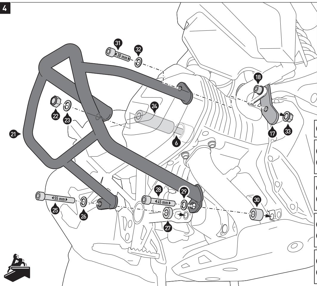
Verschrauben Sie den Sturzbügel (21) am Fahrzeug, wie in der Zeichnung gezeigt.
