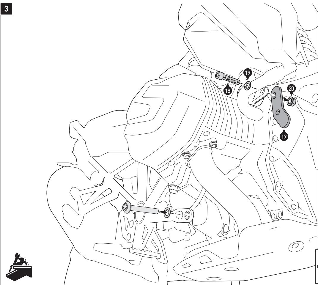
Entfernen Sie die original Motorhalteschrauben auf der **rechten** Fahrzeugseite.
