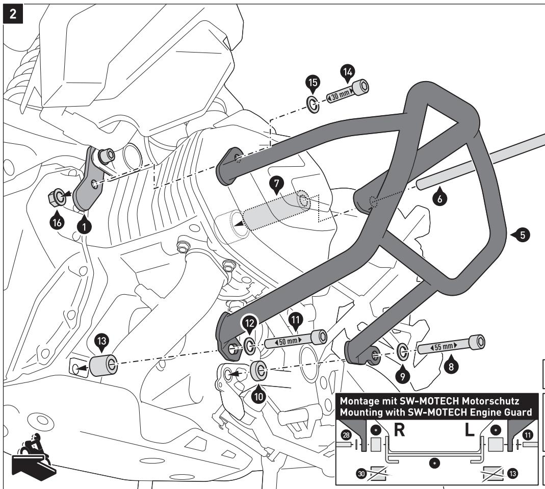
**HINWEIS:** Die Distanzbuchsen (13) und (30) entfallen bei gleichzeitiger Montage des Sturzbügels mit dem SW-MOTECH Motorschutz. Verwenden Sie an deren Stelle die dem Motorschutz beiliegenden Distanzbuchsen (\*), wie in der Detailzeichnung gezeigt.
